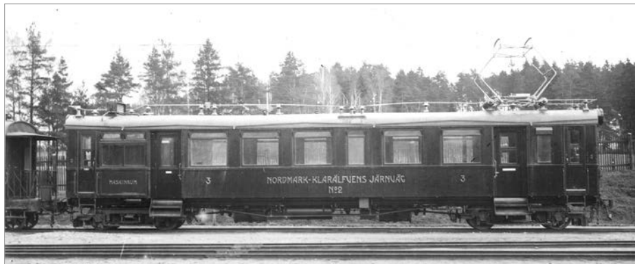
NKIJ elmotorvagn 2, ombyggd från bensinelektrisk motorvagn år 1921. Foto från 1930. Foto: Nybergsska samlingen, Sveriges Järnvägmuseum.
