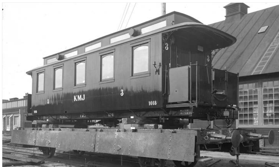
KMJ tvåaxliga C 1018 på ASJ i Linköping 1919. Vagnen har renoverats och försetts med tryckluftsbroms. På bilden upplastad på en normalspårig godsvagn för vidare transport till sin hemmabana. Foto: Nybergsska samlingen, Sveriges Järnvägmuseum.
