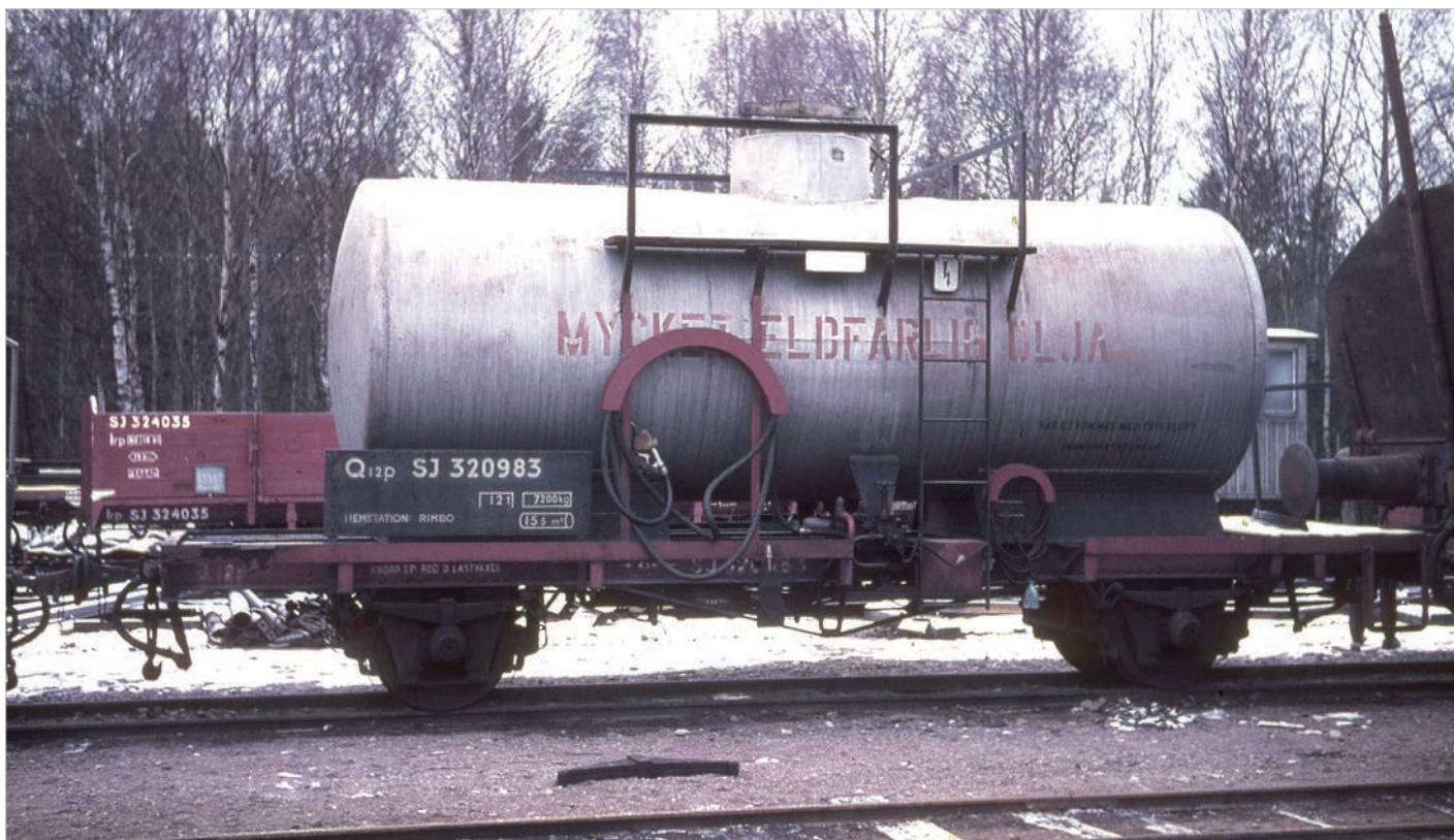
Q12p 320983 användes på 1960-talet som bränsledepå i Hallstavik och försågs därför med utrustning tankning av rälsbussar och lokomotorer. Rimbo passerades vid transport för påfyllning. Foto: Anders Jansson.
