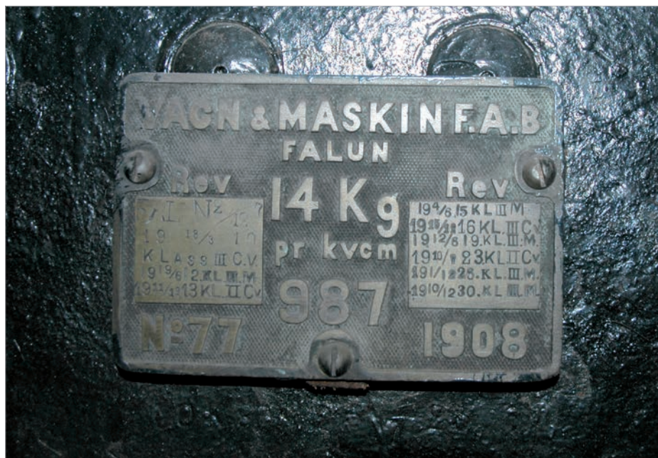
Pannskylten på SJ Tb 864 från Vagn- och Maskinfabriken i Falun 1908 med SJ pannnummer 987. Pannan låg vid leveransen i Tb 899. Foto Ulf Diehl Gävle 2009.
