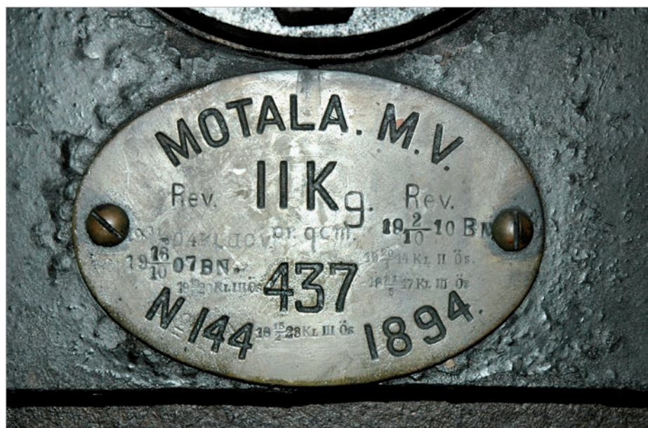
Pannskylten på SJ Kd 390 med Motalas tillverkarnummer 144/1894 och SJ pannnummer 437. Det är alltså pannan till SJ Kd 453 som på slutet hamnat i loket på Sveriges Järnvägmuseum. Foto Ulf Diehl Gävle 2009
