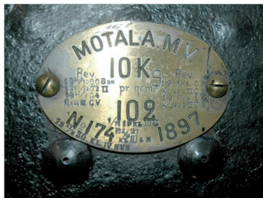
Pannskylten på SJ G 93 med pannnummer 102. Detta är en reservpanna typ Gc tillverkad 1897, men har samma tillverkarnummer som en Kd-maskin (SJ Kd 520) levererad samma år. Foto Ulf Diehl Gävle 2009
