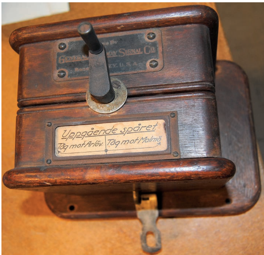
Riktningsvändare för sträckan Malmö Arlöv. Med denna kunde blocksignalerna för den normala körriktningen ställas till stopp när man behövde köra på högerspår. Foto: EmelieSvensson, Sveriges Järnvägmuseum.
