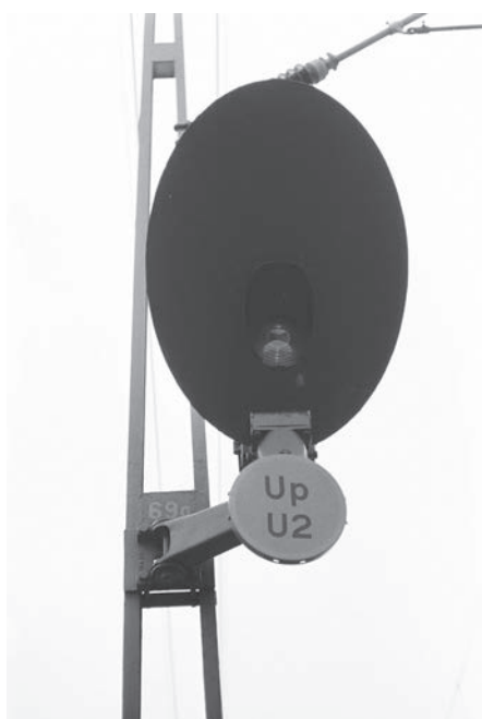
Strålkastarsignal vid Uppåkra. Tavlan med signalens namn är rund för att visa att det är en blocksignal, där andra regler gäller än vid övriga huvudsignaler
