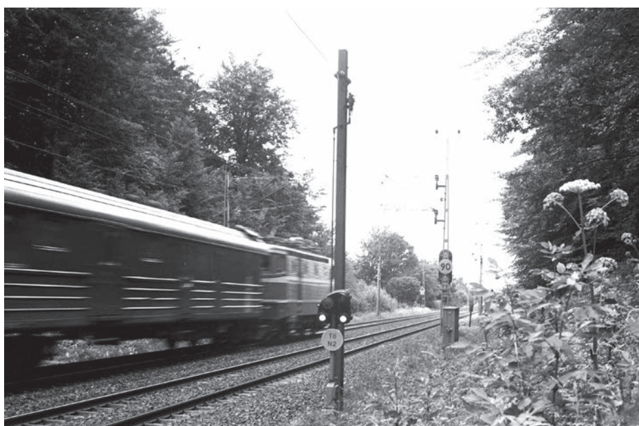
Linjedvärgsignal för högerspår vid utfarten från Tjörnarps. Längre bort syns baksidan på stationens infartssignal. Strålkastarsignalen för vänsterspår skymms av tåget.
