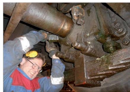
Kontroll av återledningsdon. Gunnar förevisar här den något mindre glamrösa sidan av arbete med äldre lok. Strax innan förevigandet av arbetsmomentet har såklart nån kladdig "gucka" ramlat ner i huvudet! Foto: 2014-04-26. Patric Hjelm.
