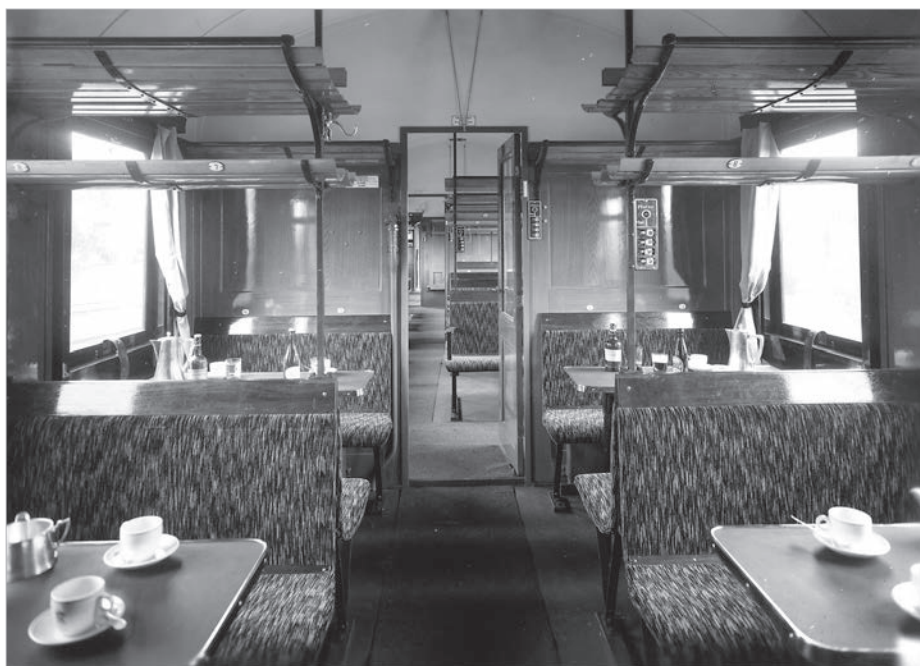
Kafévagn C08c 1933. Notera de stoppade sätena som senare byttes mot galon. Re-kryterna slet hårt på klädseln under kriget. KDAF05008
