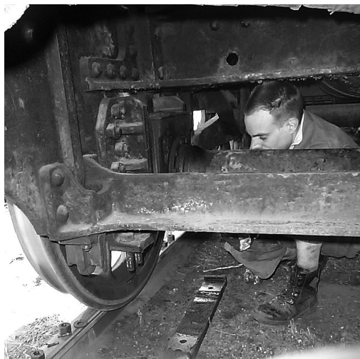
Grängesberg innan transporten. Johan von Oelreich gör översyn på samtliga storlager och smörjdynor på Sa lok 1054,1252. Foto: Per-Åke Lampemo
